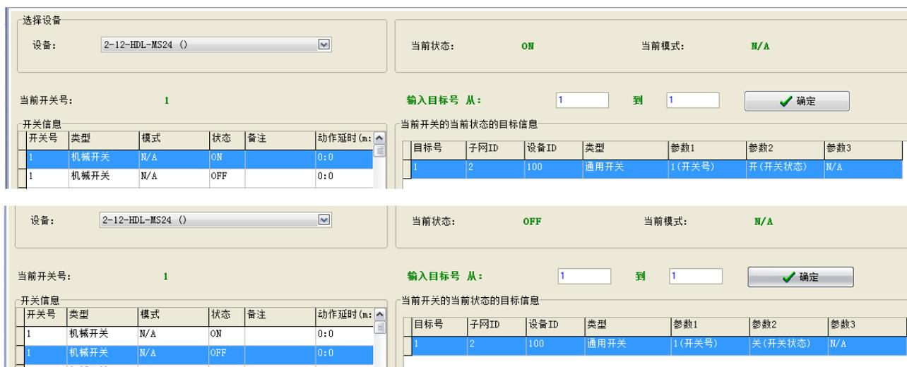
在 HDL-BUS 软件里，设置输入对应的功能，开关类型选择机械开关，子网 ID、设备 ID 必须与 inSona\_HDL\_Contact 驱动中设置的信息一致；
