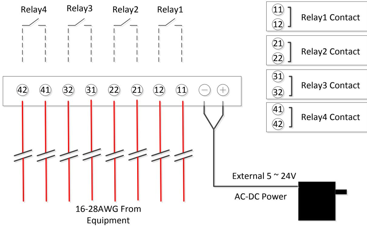
安装人员请对照此接线图进行接线
